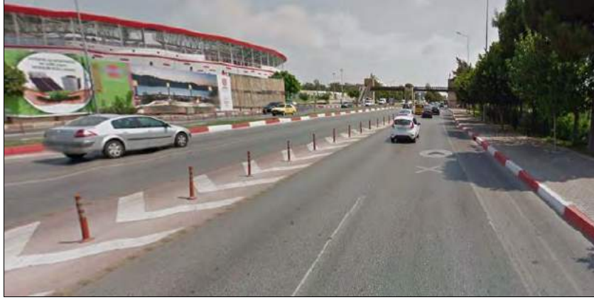
Şekil 3. Çift şeritli iki yol birleşimi ve şerit sayısının üçe düşürülmesine bir örnek.
