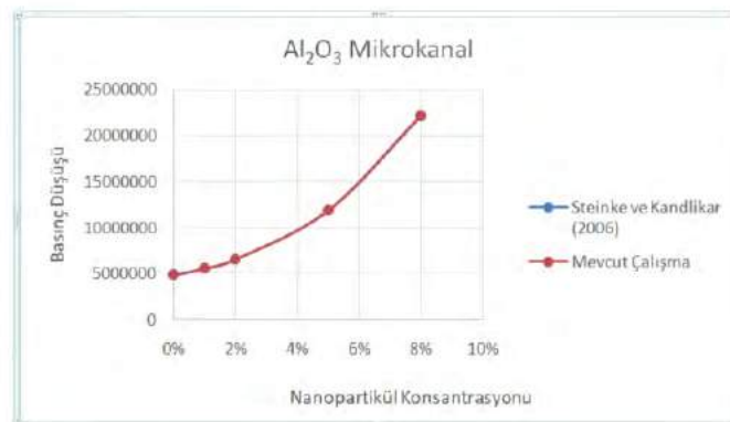
Şekil 3. Basınç düşüşünün mikrokanalda analitik ve nümerik sonuçlarının karşılaştırılması
