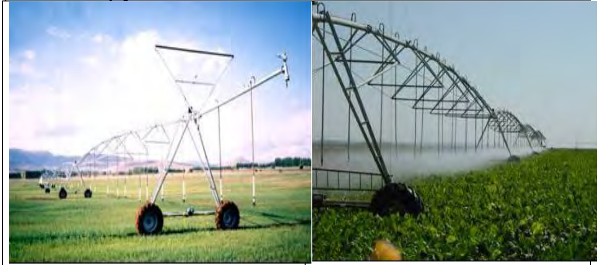
Şekil 5. Merkezi hareketli (Center pivot) yağmurlama sulama sistemleri
