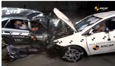
Şekil 1: 1998 model ile 2015 model Toyota Corolla'nın çarpma testi [3]
