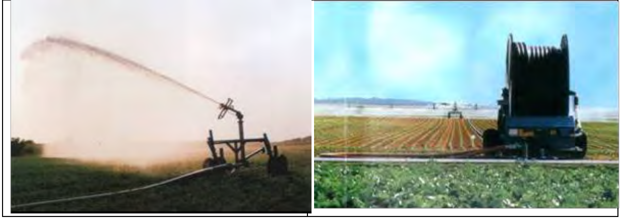
Şekil 4. Tamburlu yağmurlama sulama sistemi.
