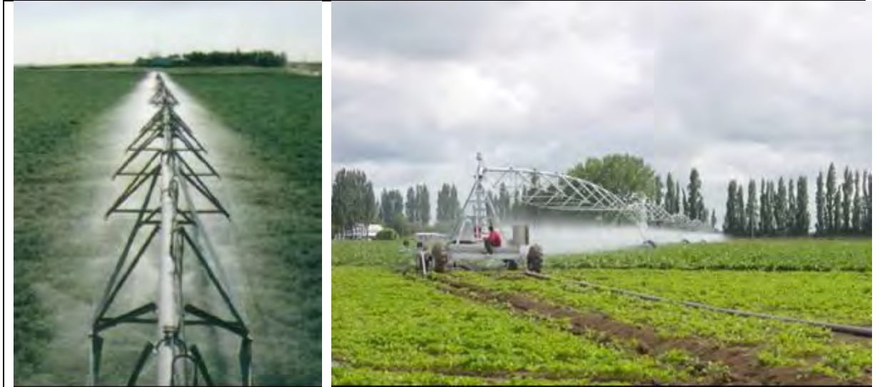
Şekil 6. Doğrusal hareketli (Lineer move) yağmurlama sulama sistemleri
