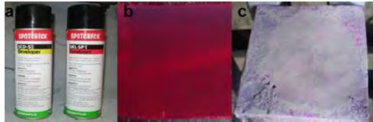
Şekil.1. Sıvı Penetrant Testi Uygulama Aşamaları
