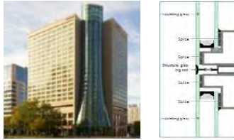
Resim 2.A. LEED Sertifikalı Westin Warsaw Hotel, Polonya [6] Resim 2.B. Strüktürel Macun Taşıyıcı Cephe Cam Birleşim Detayı [7]
