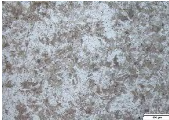
Şekil 1. Aisi 303 Paslanmaz Çeliğin Optik Mikroyapısı
