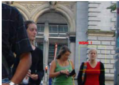
Resim 1. Haar Cascade yönteminin hatalı tespit ettiği görüntü
