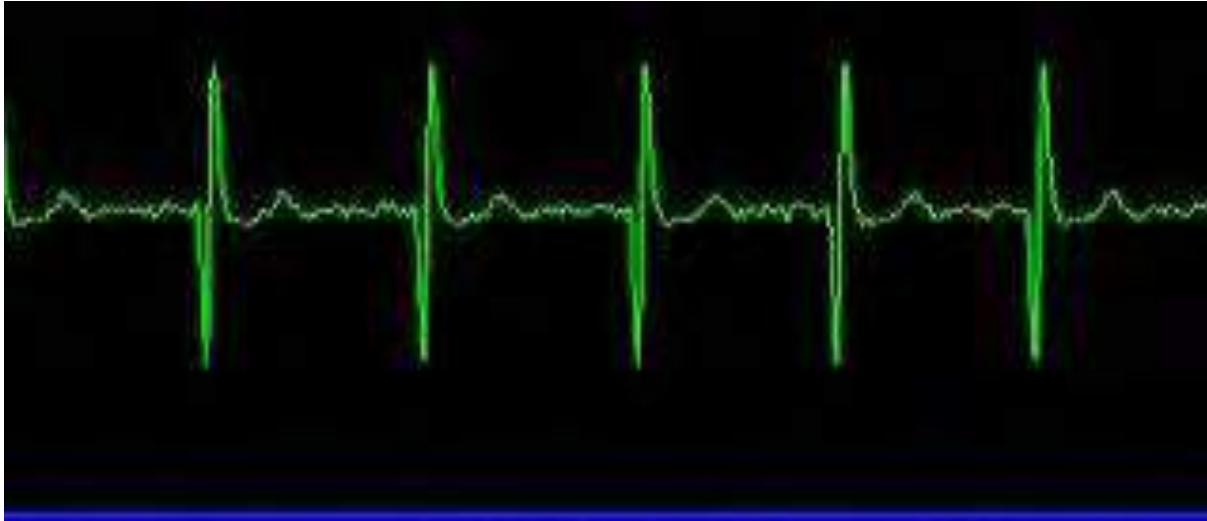
Şekil 3. Tasarlamış Olduğumuz EKG Cihazımızdan Almış Olduğumuz Sinyal Örneği.
