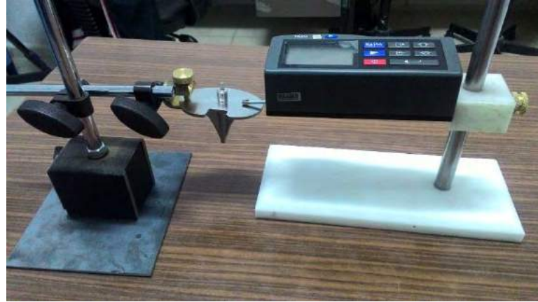
Şekil 2. Pürüzlülük Ölçüm Düzeniği
