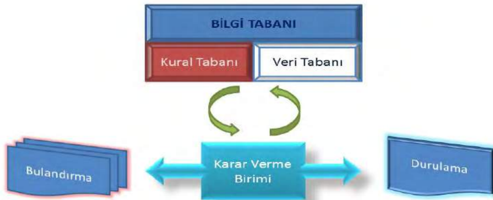
Şekil 1. Bulanık Mantık Denetleyicinin Temel Yapısı
