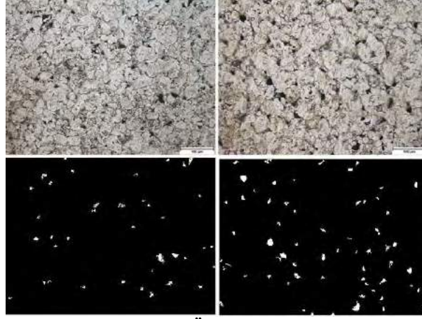
Şekil 4. AISI 303L 130MPa Basınçla Üretilen Numunenin Mikroyapı Görüntüsü
